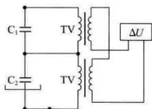
图 6.1.2-2 单星形电容器组相电压差动保护原理接线
