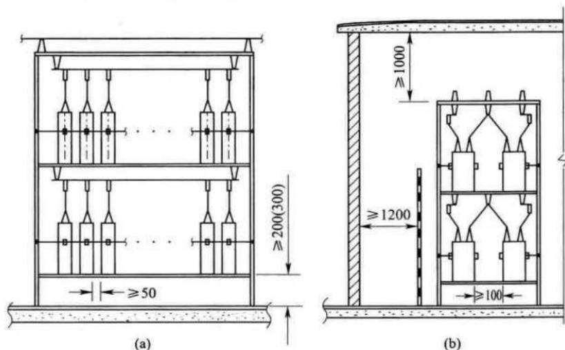
图 1 并联电容器组安装示意图
