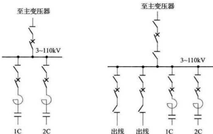
图 4.1.1-1 同级电压母线上无供电线路时的接线方式
