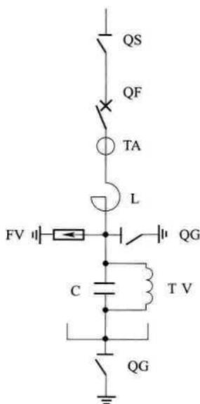
图 4.2.1 并联电容器组与配套设备连接方式
