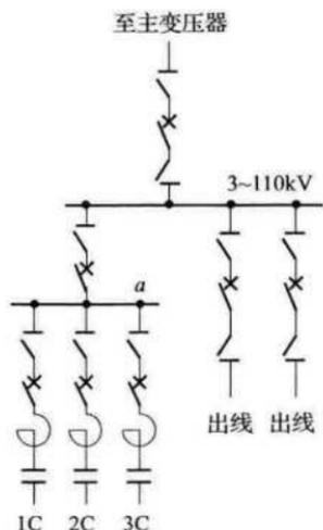
图 4.1.1-3 设置电容器专用母线的接线方式
