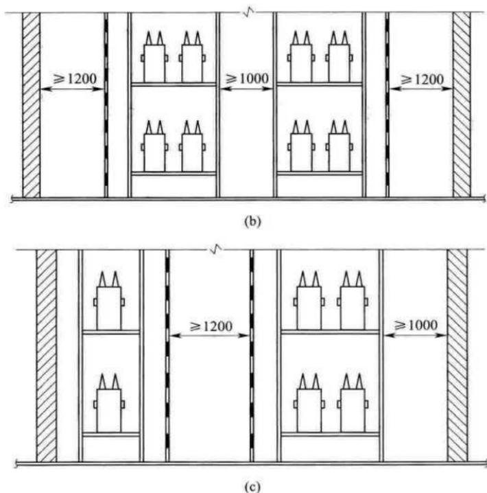
图2 屋外并联电容器组通道(走道)设置示意图
