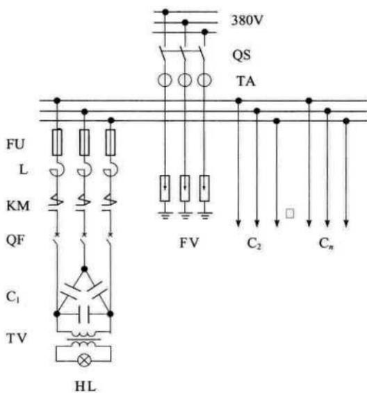
图 4.2.9 低压并联电容器装置元件配置典型接线
