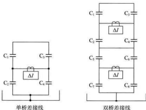
图 6.1.2-3 单星形电容器组桥式差电流保护原理接线
