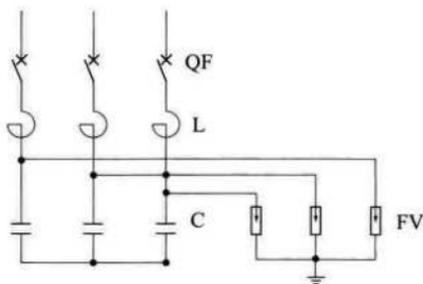
图 4.2.8 相对地避雷器接线
